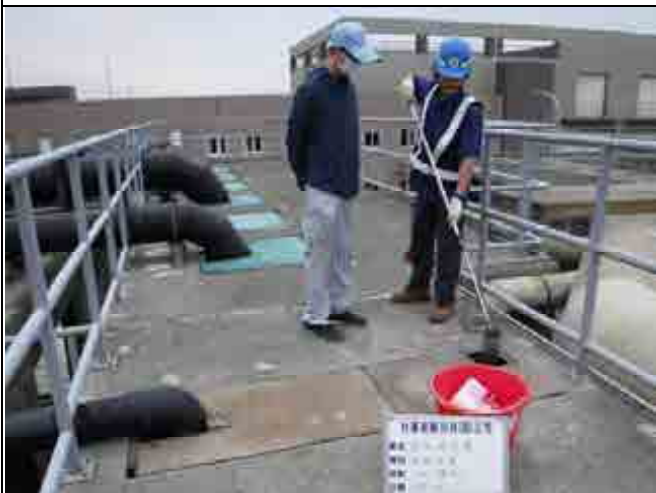
項目：進流水質 日期：107.04.27 地點：污水處理廠進流口
