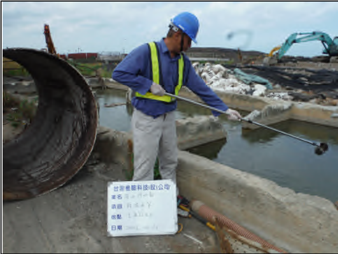
項目：放流水質 日期：104.06.30 地點：工區排水放流口
